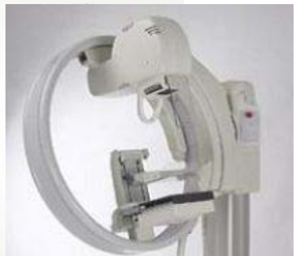
IMS Giotto TOMO a:Se, pixel 85 \mu\text{m} W/Rh, W/Ag 13 proiezioni, range 40° 12 sec.
