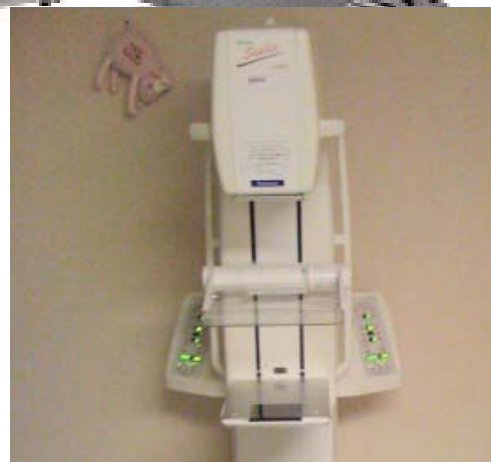
Planmed Nuance Excel DBT a:Se, pixel 85 \mu\text{m} W/Rh, W/Ag 15 proiezioni, range 30° 20 sec.
