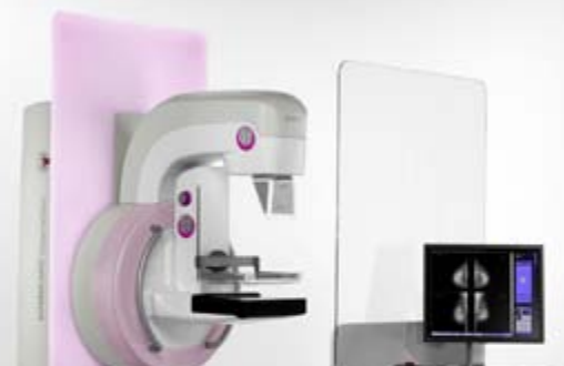
Siemens Mammomat Inspiration a:Se, pixel 70 \mu\text{m} W/Rh 25 proiezioni, range 50° 25 sec.
