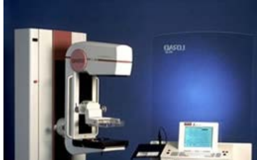
Hologic Selenia Dimensions a:Se, pixel 70 \mu\text{m} W/AI 15 proiezioni, range 15° 3.5 sec.
